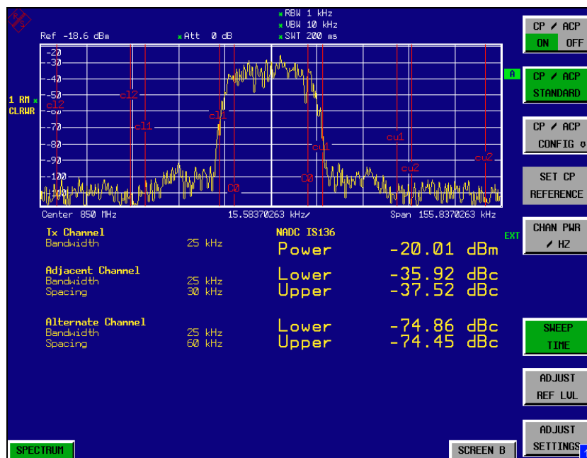
Bild 2.31 Messung der relativen Nachbarkanalleistung eines NADC-Signals in je zwei Nachbarkanälen unterhalb und oberhalb des Sendekanals.
